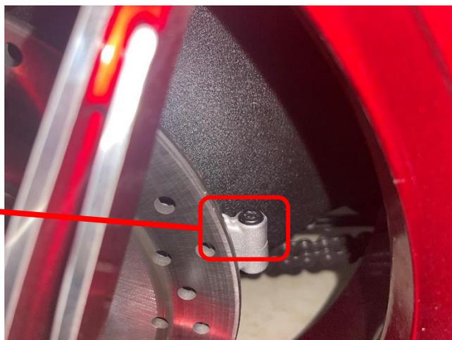
步骤二：拆卸制动钳支撑板**一颗**紧固螺栓。
