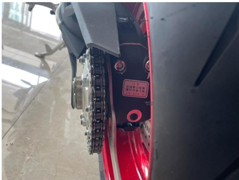
步骤三：使用起车架将后轮架起，再用专用工具卡入凸轮鞍调节处。
